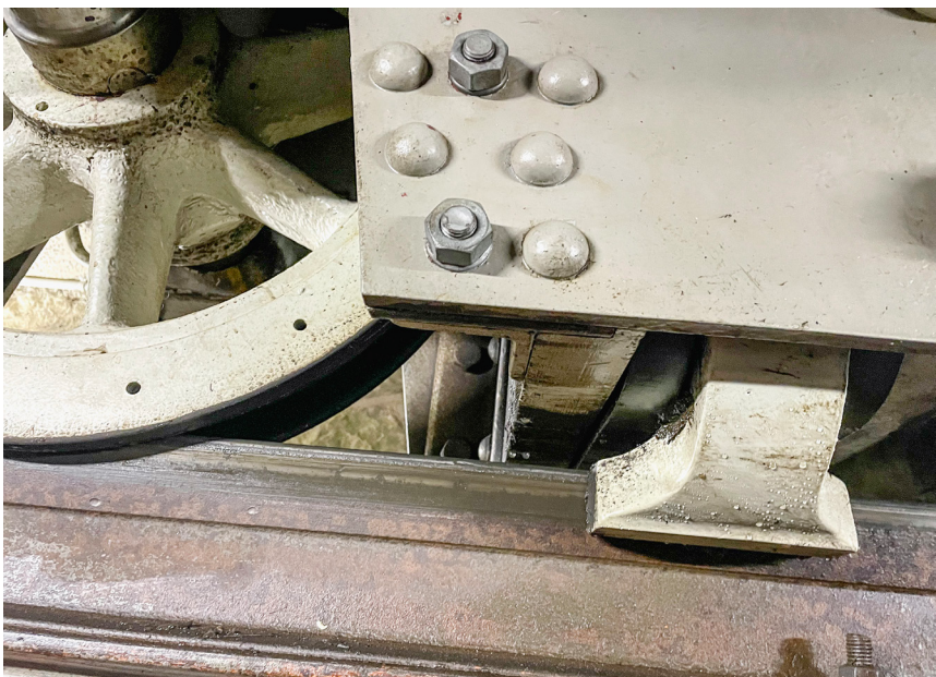
Die Fangbremse klemmt sich im Notfall wie ein Greifer um die Schiene und dient so gleichzeitig als Entgleisungsschutz.
