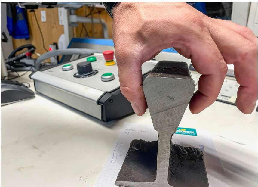
Am Querschnitt eines Gleisstückes zeigt Andreas Wiedmer mit seiner Hand, wie die Fangbremse sich um den Schienenkeil schliesst.
