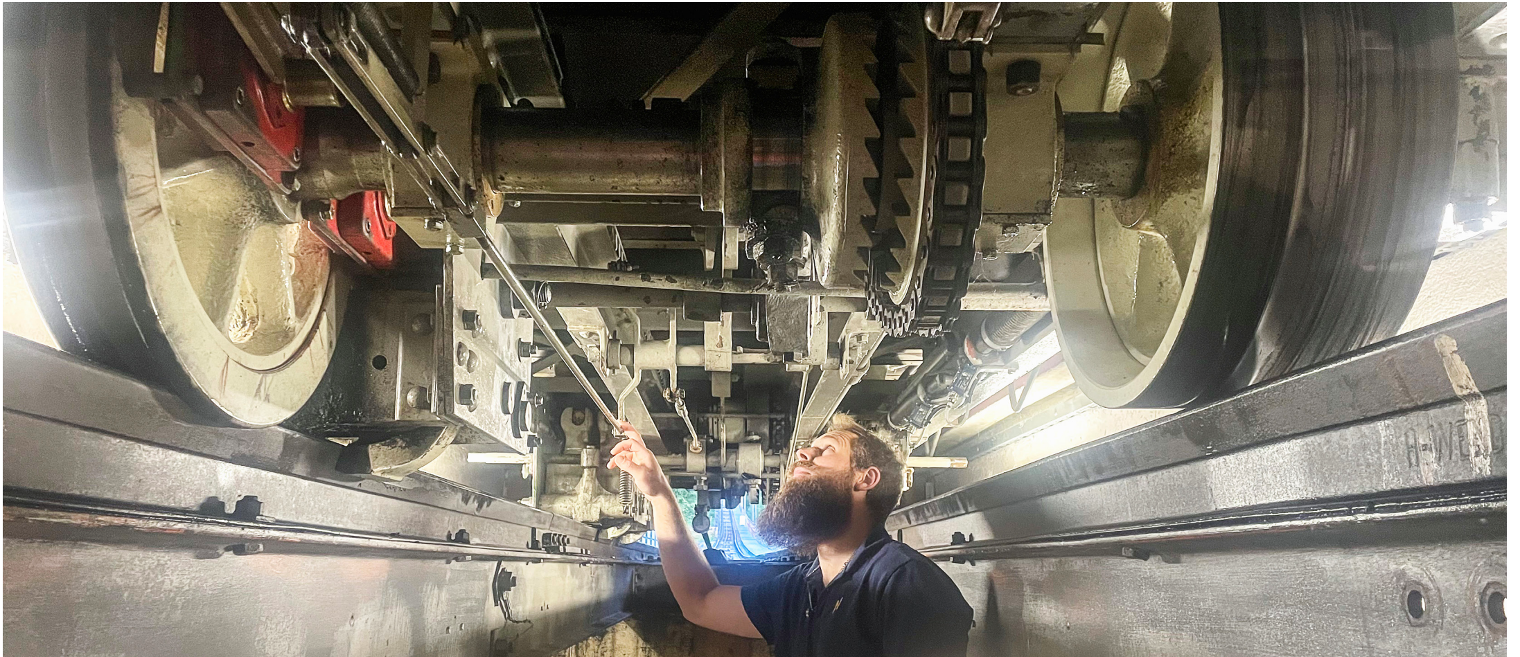
Andreas Wiedmer, Leiter Betrieb und Technik der Niesenbahn, erklärt unter dem Waggon die Fangbremse und die Unterschiede zum System in Lissabon.
