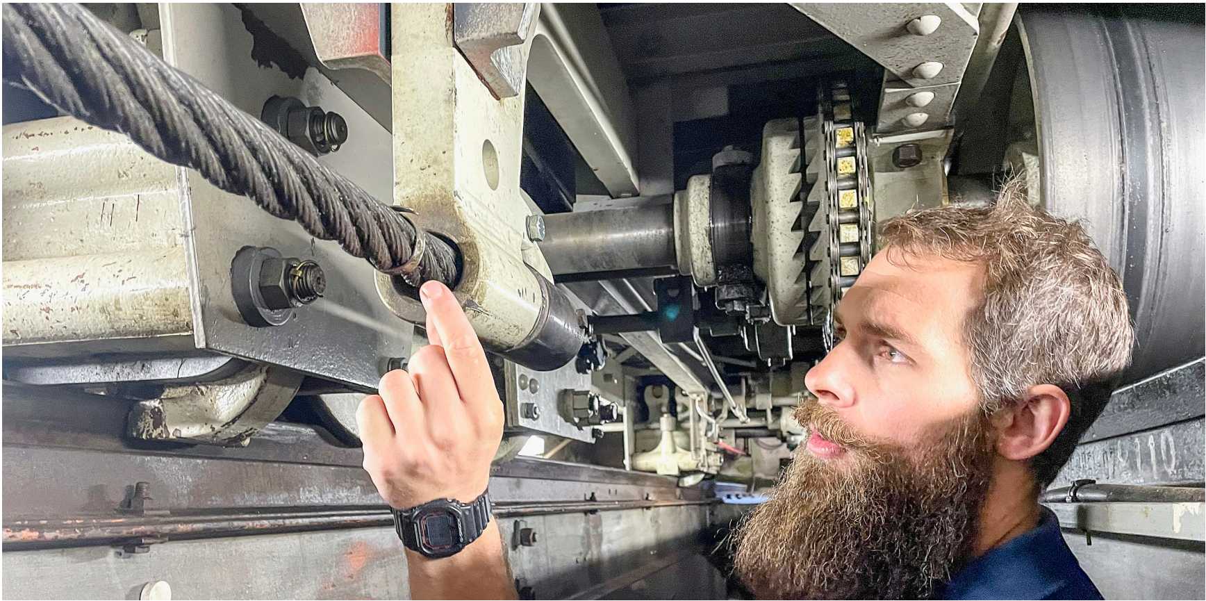
Andreas Wiedmer zeigt die Stelle, an der das Seil über den Seilhebel mit dem Wagen verbunden ist. An dieser Stelle orten die portugiesischen Experten die Unfallursachen im Fall Lissabon.
